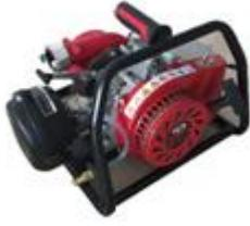
名称高扬程三级森林消防泵(电启动) 型号 SFBC10/2 (E)启动方式手拉启动/电启动发动机型号 1E64F (可选进口动力) 标定功率 5.9kW/7000r/min 额定流量 1.5L/s 额定压力 1.2MPa 最大扬程 160m 最大流量 20m<sup>3</sup>/h 自吸高度 7m 水枪射程 23~25m 油箱容量 23L/15L 连续工作时间大约 6h/4h 净重 15kg 外形尺寸 mm370×450×300mm
